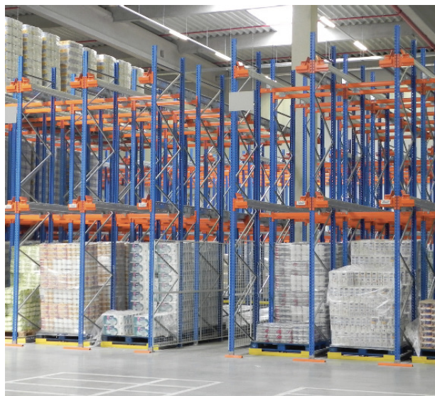
Instalação dinâmica de paletes com solução de shuttle acima
