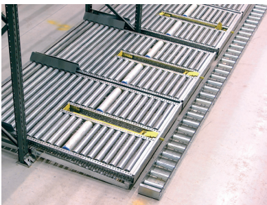
Trilho de rolamentos dianteiro para movimentação de paletes vazias
